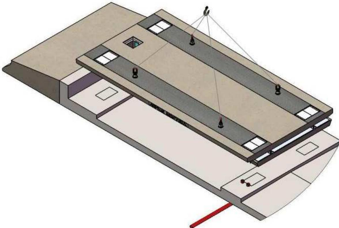
13. Descendre soigneusement le module en s'assurant du passage correct de la butée préalablement installée au travers de l'ouverture prévue à cet effet.
