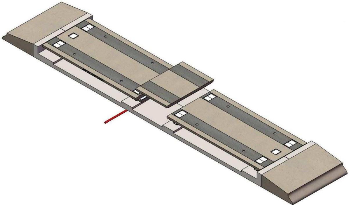
23. Vérifier le jeu en entrée et sortie de pont, l'alignement des modules, si tout est correct procéder à la fixation des plaques d'appuis capteur par 4 x SPIT M12 + 4 rondelles Ø16.
