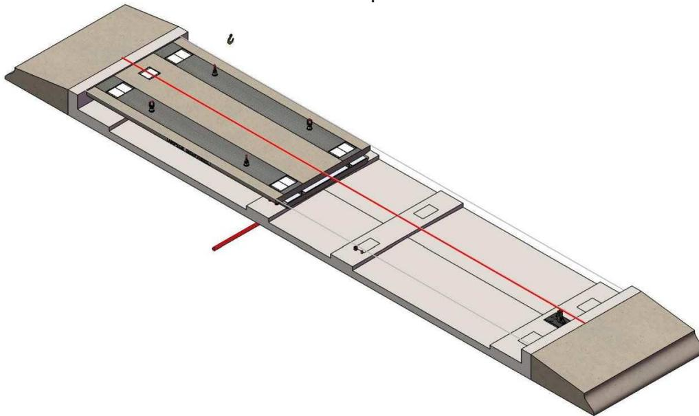
16. Si nécessaire reprendre le positionnement du module pour l'aligner avec le cordeau
