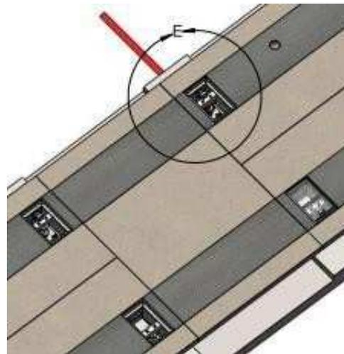
Fixer les boîtes de raccordement sur le pont avec la tôle et la pince prévues à cet effet.
