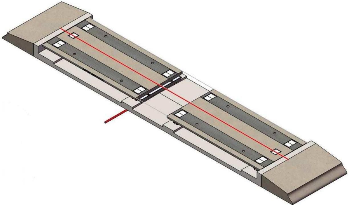
19. Mettre en place les 2 bandes de joint élastomère DILAST sur chacun des modules peseur AVANT de mettre en place la passerelle.
