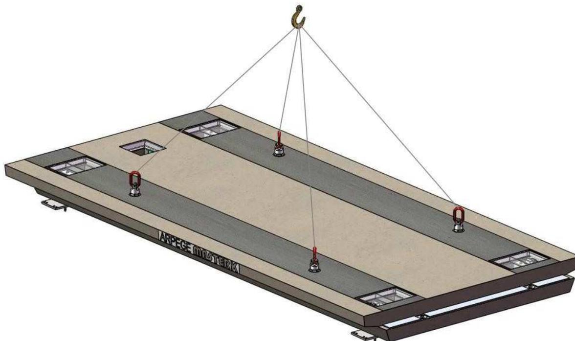
Les modules ne doivent en aucun cas être posés directement au sol : pour le module central (positionné en dernier) et (ou) dans le cas où le pont n'est pas installé immédiatement et qu'il doit être stocké, Les modules doivent être posés sur des bastaings en bois correctement dimensionnés sur une surface plane.
