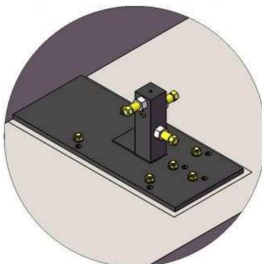
*Si la longueur entre muret est dans les tolérances du plan de GC, positionner la butée en appui contre le muret comme ci-dessous.*
