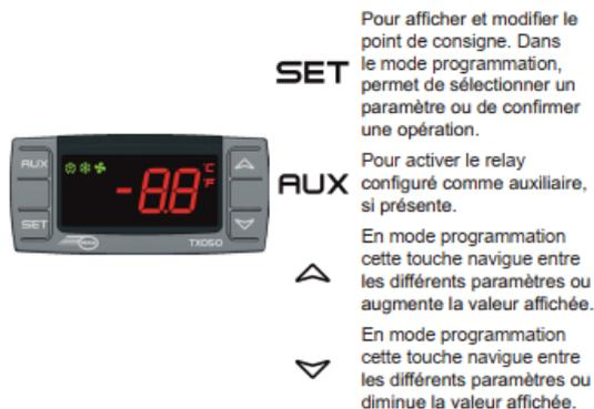
Clavier du régulateur digital avec touches de réglages
